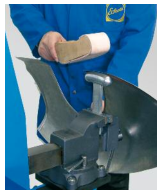
Tornillo de banco, giratorio, de altura regulable, y apto para sujetar el cabezal de los dispositivos de la moldeadora manual u otros accesorios (por ejemplo, yunques en T)
