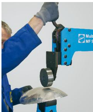
Mecanismo de afloje rápido para amarrar y soltar el útil.
